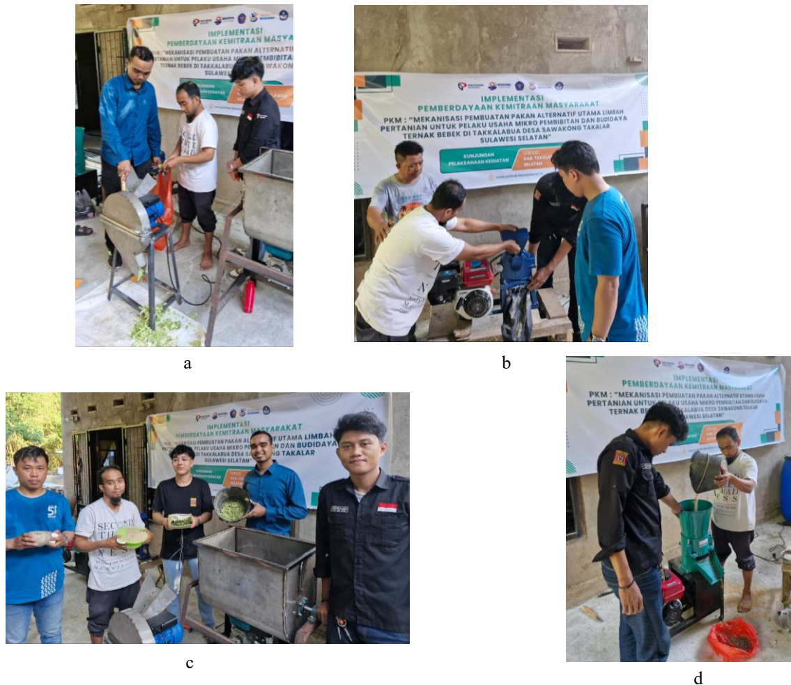
Gambar 6. Demonstrasi penggunaan mesin-mesin pengolah pakan; a) Mesin chopper ; b) Mesin Penepung; c) Mesin mixer ; d) Mesin pelet
